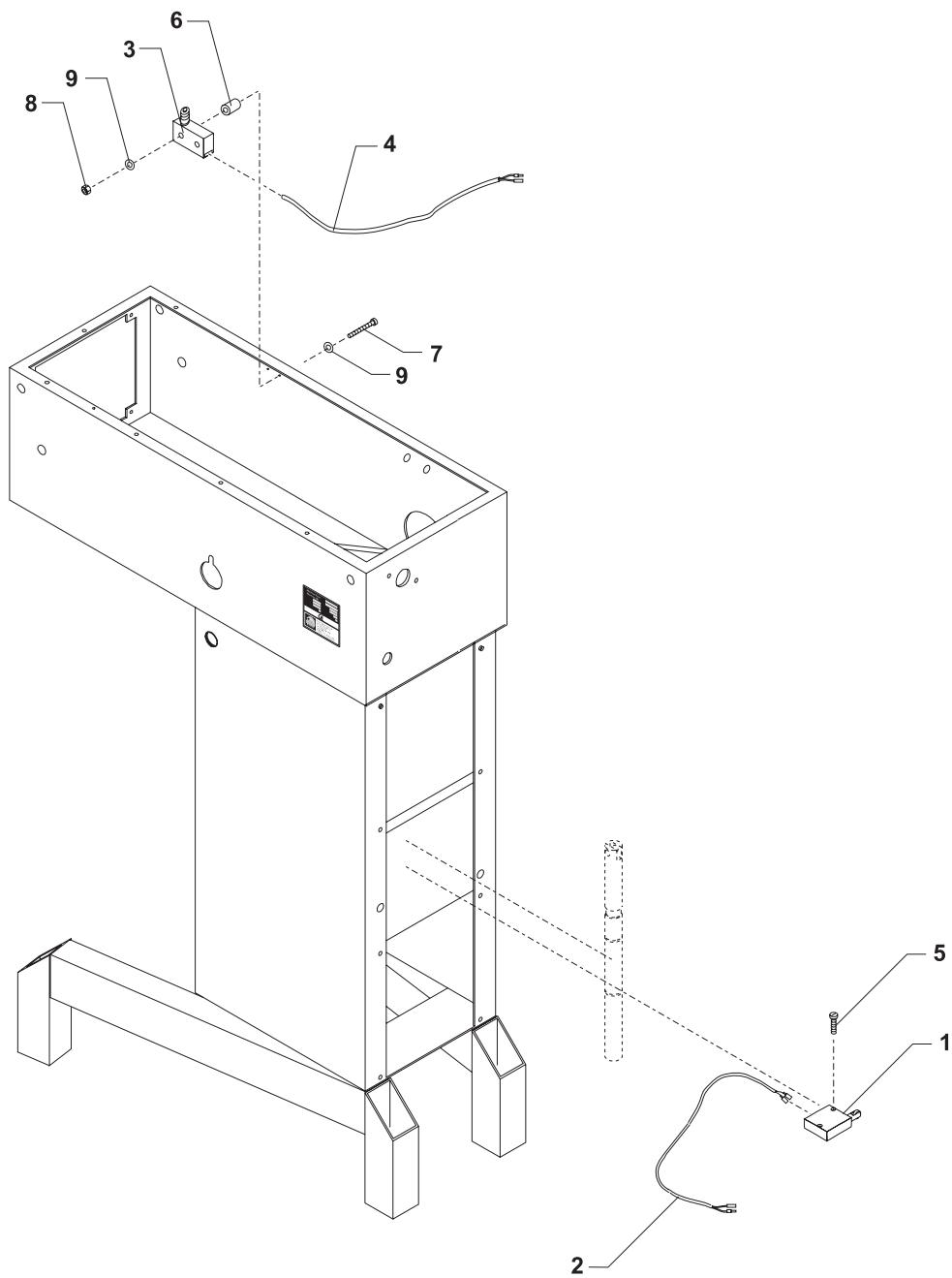
AR31-194.11M.....GS microswitch monteret ..... GS micro switch mounted ..... GS Mikroschalter montiert
